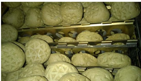
Ein im Ofen montierter Behälter mit aufgelegten Tetra-Steinen.
