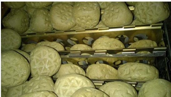
Nádoba nainstalovaná v topidle s kameny Tetra nahoře.
