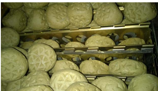
Pojemnik zamontowany na piecu pokryty kamieniami Tetra.
