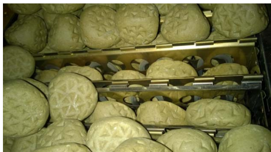
Conteneur installé dans un chauffe-sauna recouvert de pierres Tetra.
